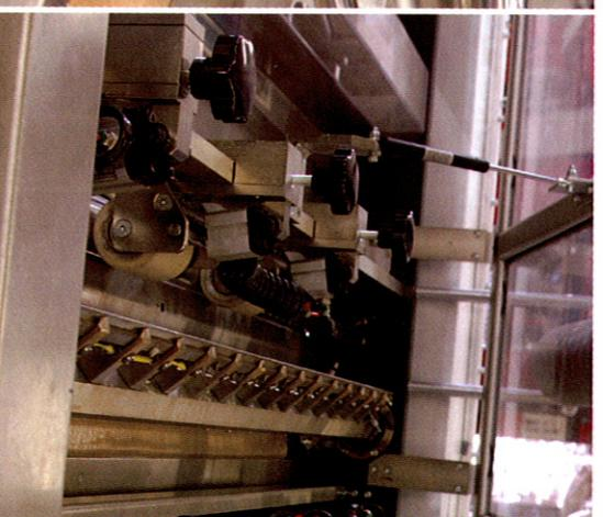
*Sistema di taglio a lama calda rotante, per la separazione in linea ad alta velocità di film in poliestere, nylon, goffrati olografici e metallizzati.*
