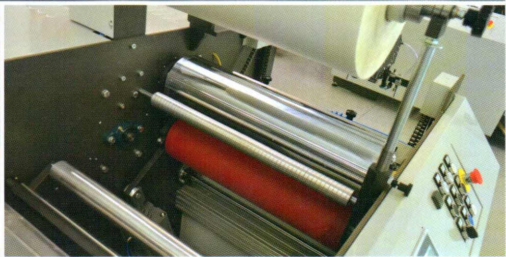
▲ Mettifoglio automatico di elevate prestazioni High performance automatic feeder
