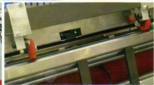
▲ Fotocellula di stop per mancanza foglio Sheet missing photocell stop
